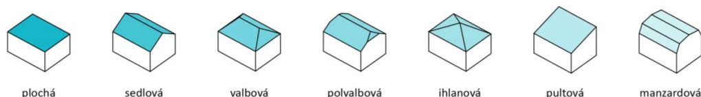
Tabuľka č. 58 Schéma základných typov strešných konštrukcií
